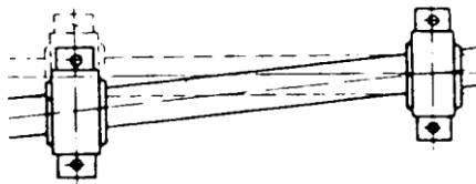
Afb. 6 Kussenblokken niet in lijn met de as
